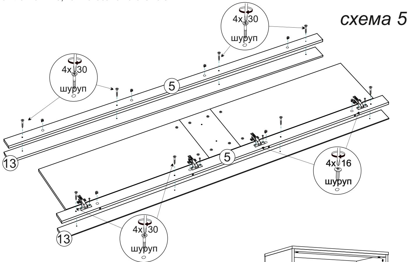
7. Установите собранные створки с планками на боковины шкафа, вставив заранее ввернутые в бока штока эксцентриков в соответствующие отверстия на планках №5 а затем затянув эксцентриковые стяжки. Установите полки №7 или штангу №15, как показано на схеме 6.
