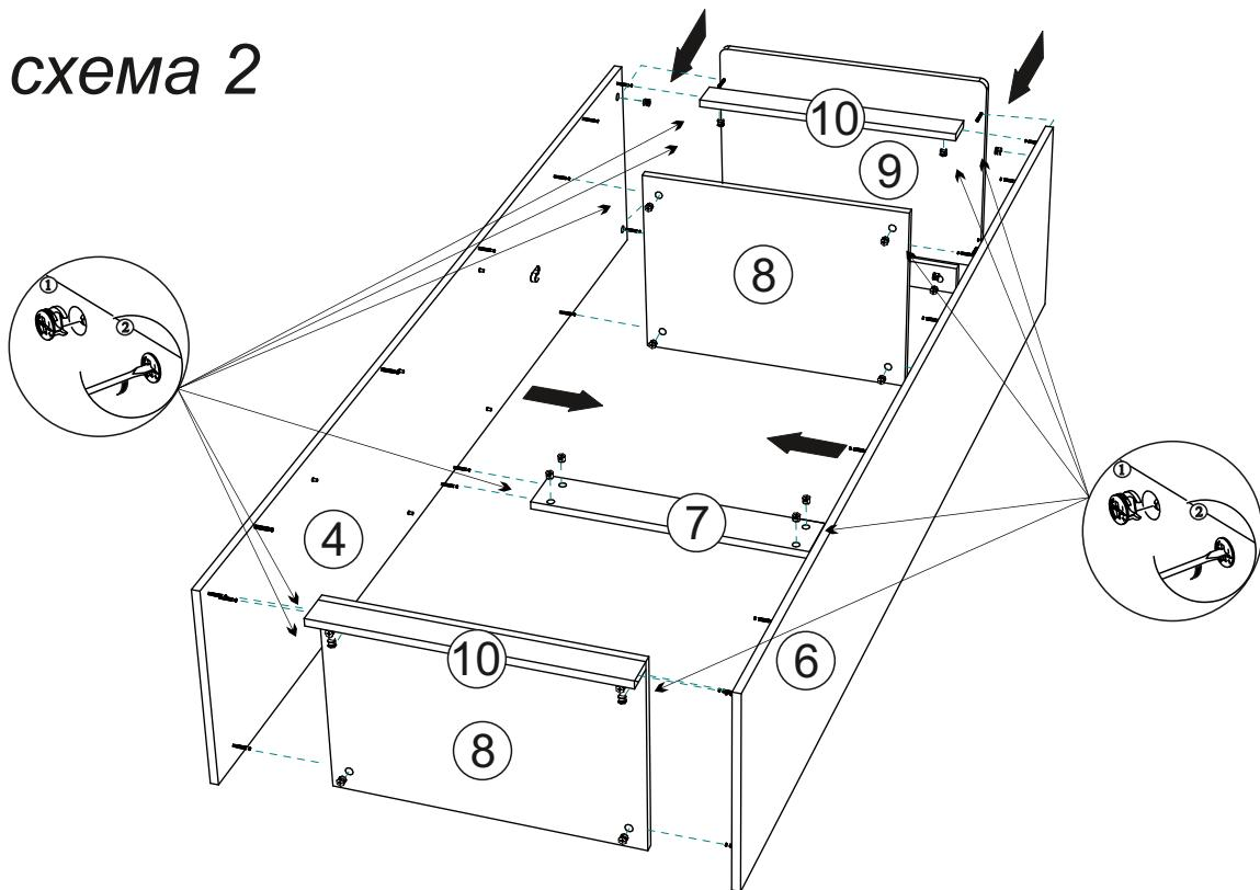
4. Чтобы установить задние стенки (деталь №1 и №2), необходимо собранную конструкцию перевернуть лицевой стороной вниз. Замерить, с помощью рулетки, и уронять диагонали (а=б). Наложить задние стенки, предварительно соединив их профилем для ДВП №18 и аккуратно, не нарушая диагоналей, прибить ЛДВП гвоздями, с шагом 130-150 мм, затем также гвоздями прибейте подпятники на боковины и планки, (схема 3).
