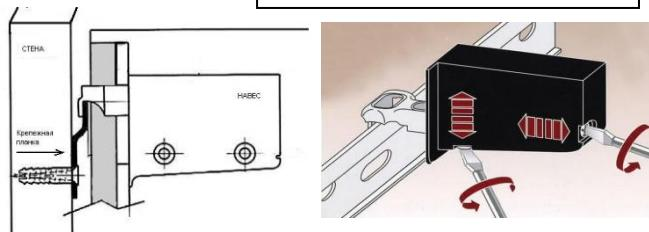
Рис. 3 Схема регулировки навесов
