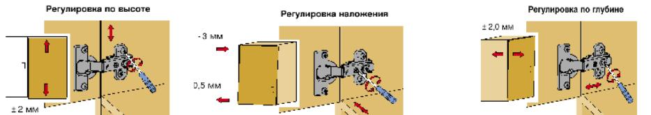
Следка ослабить крепежные винты ответной панели, вывернуть по высоте позицию двери. Затом крепежные винты снова затянут.
