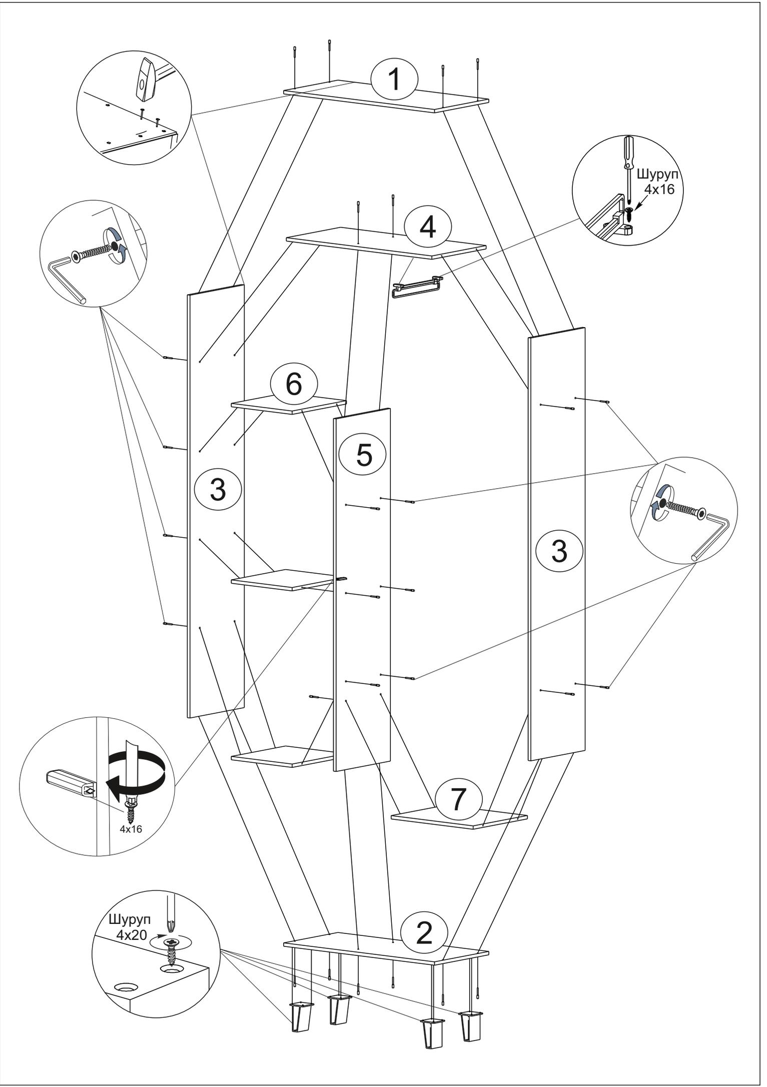
Для более прочного соединения рекомендуем шканты смазать клеем
